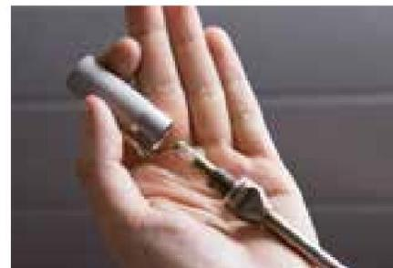
Sonda de filtro sinterizado
